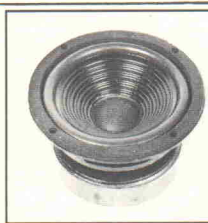
WSP 13 S: Kompakt-Tieftonlautsprecher in HiFi-Qualität mit Polypropylen-Membran, große Partialschwingungsfreiheit, sehr breitbandig einsetzbar, 45/55 W, 30-6000 Hz, 131 mm Ø
